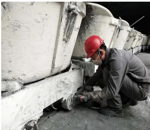
2019年9月起逐步将车间13#炉1#、11#炉2#、13#炉3#炉眼45个出炉小车轴承座逐步改用石墨粉充当小车润滑剂，由于添加过程需要逐个拆开轴承座，共计180个轴承座，720个螺栓，4名维修工，4天时间完成润滑保养工作。
