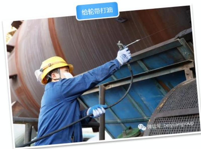
窑筒体下打油、巡检、测温、抄表、写记录、调整筒体风机位置、清理窑头到窑尾的卫生。完成这些工作本来就不容易，可在特殊时期，他的工作做的比平时更细了，比平时更吃苦。
