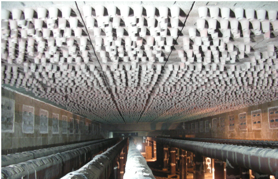
图1 黑体元件布置示意图
