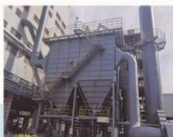
中泰化学40500KVA密闭电石炉炉前排烟除尘系统
