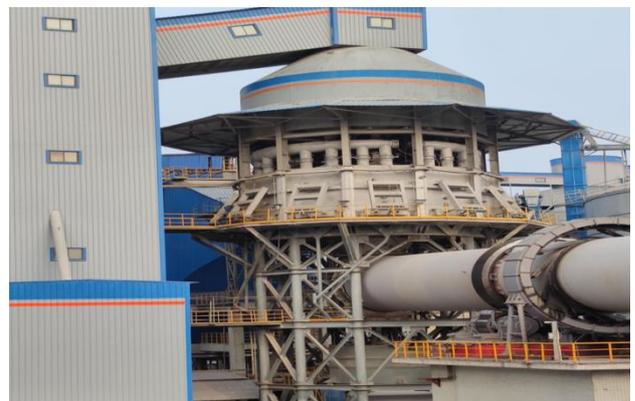
现象。②改变预热器通风梁结构，增加预热室热容量，提高预热器预热时间，充分利用余热，预热器通风分料梁通过结构改变增加预热室容量 9m<sup>3</sup>，增加石灰石
